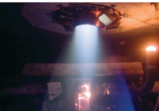
В Эймсоновском исследовательском центре NASA мощная реактивная струя, нагретая до нескольких тысяч градусов, обдувает экспериментальный материал для теплозащитного экрана
